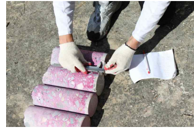
3. 탄산화 깊이 측정
