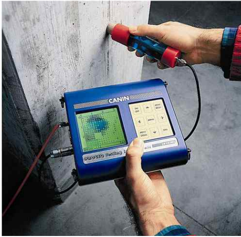
[해설 사진 2.5.4] CANIN장비를 사용한 철근부식 측정 전경 및 결과
